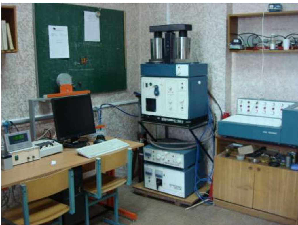
Экспериментальная установка на базе дериватографа Q-1500D
